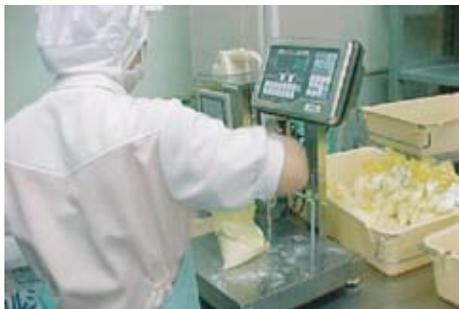
上：計量工程で原料の2次元コード読む作業。2次元コードから品種、消費期限、ロット、容量データを読み取っている。
