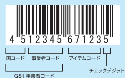
図2 JANコード (13桁) の詳細例
