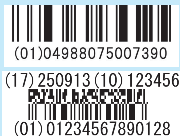
図3 GS1 データバー (上) / GS1 合成シンボル (下) (CC-Aタイプ)
