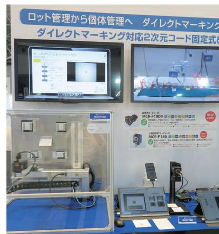
は、機械式フォーカス・ズーム機能により、様々な距離と倍率で読み取りが可能となります。デモでは、異なる距離の極小DPMシンボルを同じ画面（同じサイズ）で読み取ったり、角度のある取り付け時でも「台形補正機能」で正確な読み取りができることや、5MピクセルグローバルシャッターCMOS搭載により、画角内にある5つのコードを一度に読み取るなどの性能をご紹介しました。
