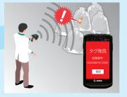
試薬番号をもとに、試薬の探索を行います。電波強度を バーと音で表示します。バーが高くなるにつれ近くに対 象試薬が存在することを意味します。
