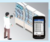
棚卸も、一本一本の瓶を持って向きを変えてバーコードを読 むということをしなくても、UHF 帯RFID なら離れた所から でも読み取ることができます。一部のIC タグが読み取れな い場合にはバーコードで読取ります。
