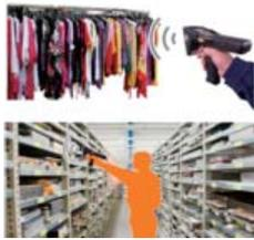
UHF 帯商品タグを採用する事により、陳列、棚商品に UHF 帯ハンディリーダーをかざすだけで商品の在庫状況が
