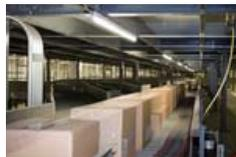
これまでの、ソーターラインの投入時に荷物に貼られた配送バーコードを作業者がハンドスキャナで読み取らせてから荷物を投入していましたが、ICタグ付きの配送ラベルを採用する事により、作業者はソーターラインへただ無作為に投入すれば良くなりました。
