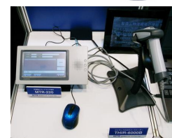
ICカード作業員証による 作業実績収集システム
