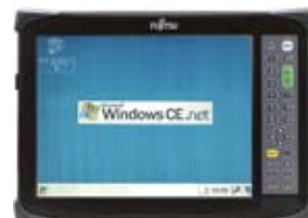
TeamPad 7500W オープンプラットフォームWindows CEを採用。10.4型大型液晶タッチパネル搭載の多機能型PDA端末。工程管理業務や店舗の棚卸しなどで採用
